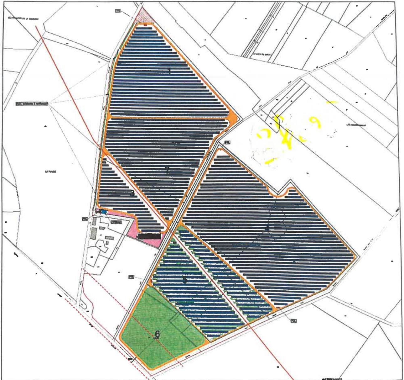
**Cartographie du projet agri-photovoltaïque** composé d'une surface maraîchère sans panneaux (zone 6), d'une surface maraîchère avec panneaux (zone 5), d'une surface réservée au projet volailles avec emprise de panneaux (zone 1, 2, 3 et 4), et d'une surface réservée à la construction du bâtiment agricole (violet foncé au centre).
